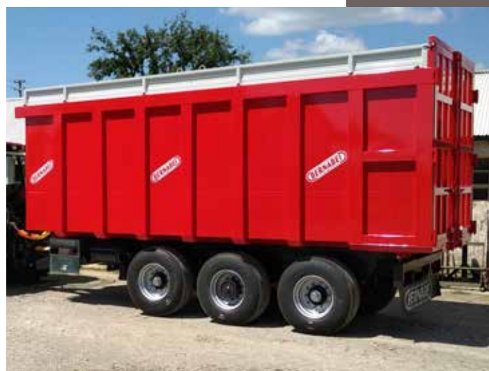
D402 con asse centrale motrice.
