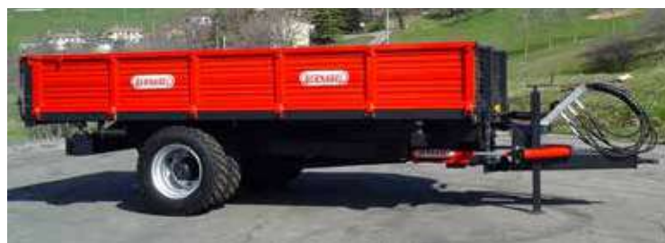
TR70 con timone sterzante e ruote gemelle
