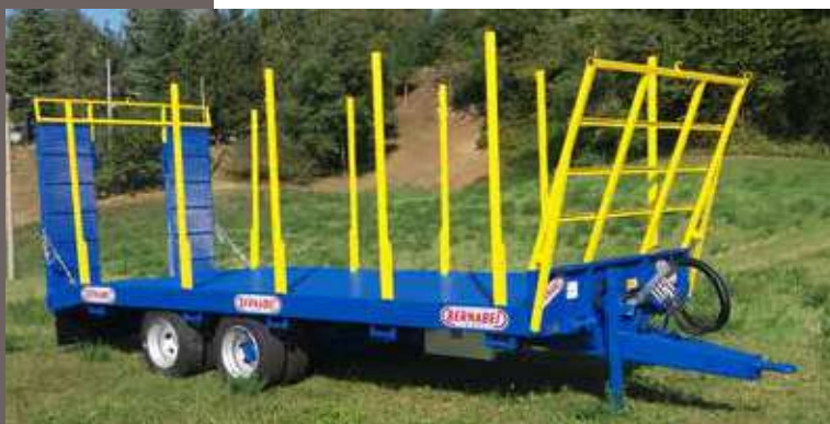
B282 con telaio anteriore e pali laterali per trasporto rotovalle
