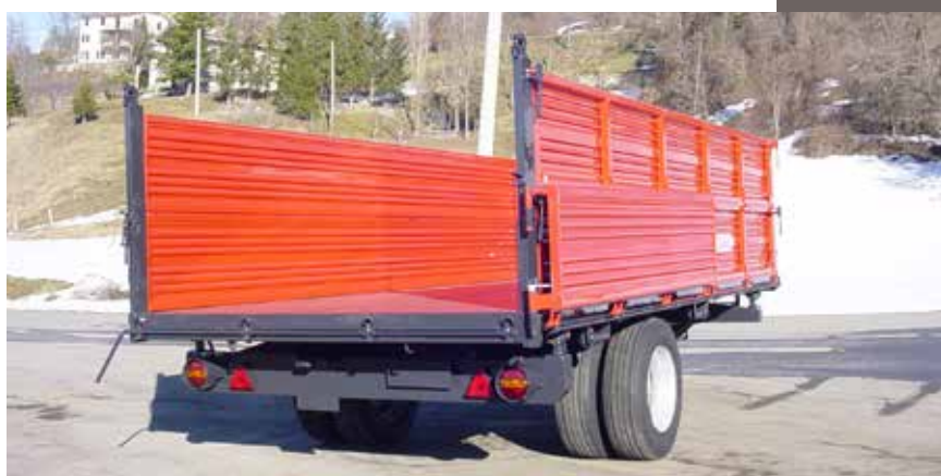
TR90F con doppie sponde, apertura sotto/sopra laterale e sponda posteriore con apertura a bandiera
