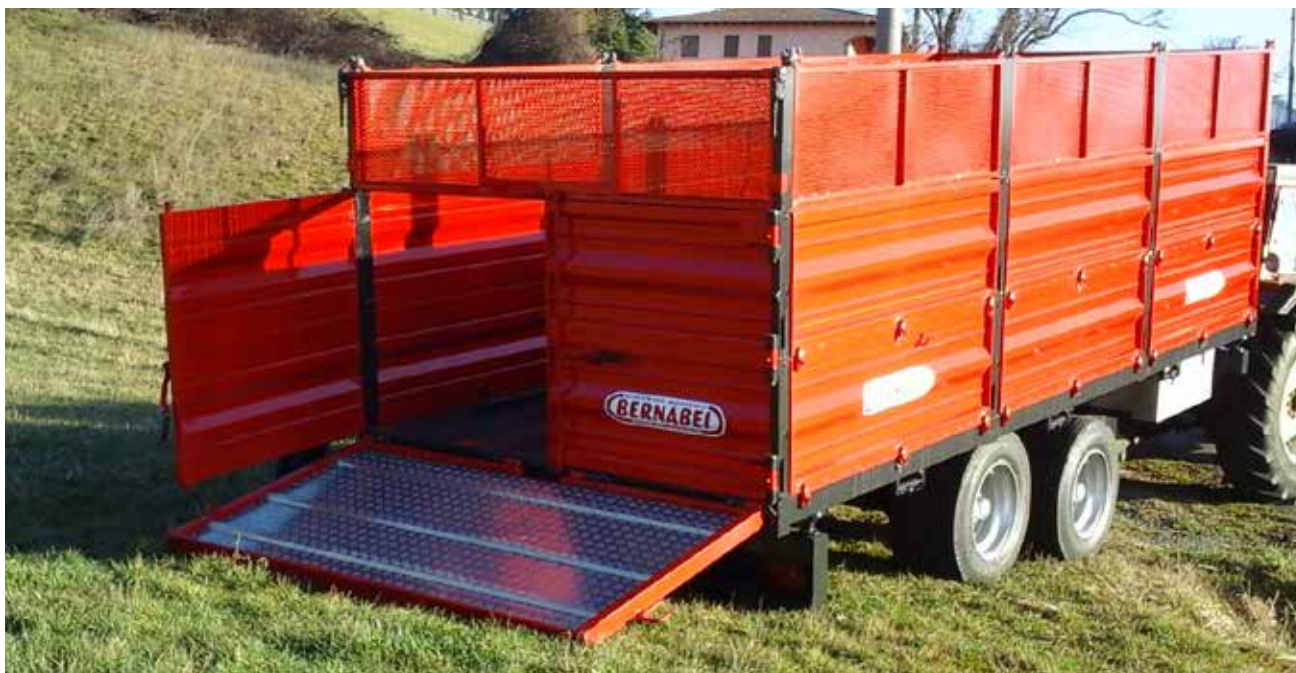
R14DU rimorchio doppio uso allestito con doppie sponde in lamiera e terzo giro in lamiera forata. Doppi piantoni laterali, sponda posteriore tipo container con rampa.
