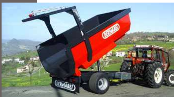
D60 lamiera vasca in acciaio antiusura
