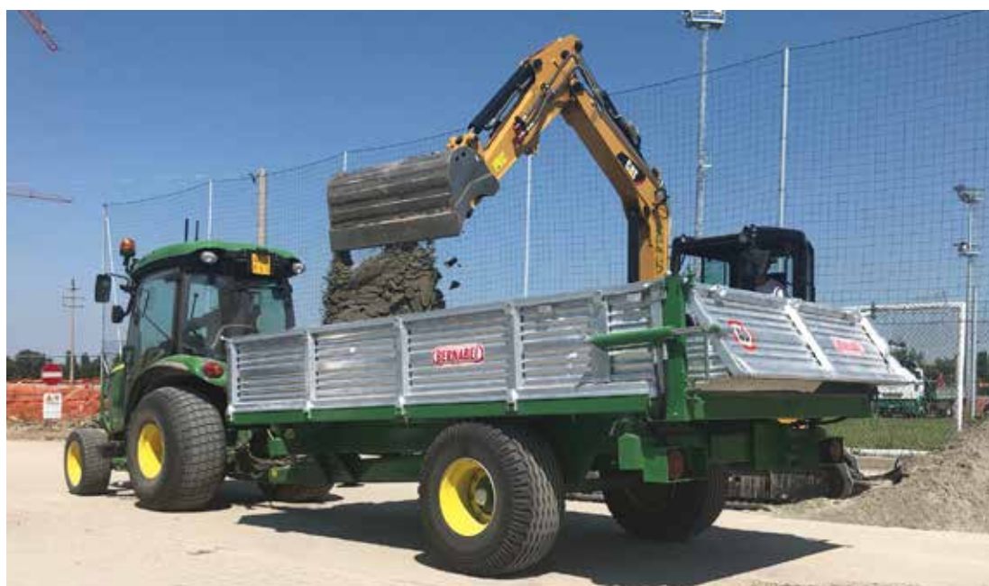
T66 con sponda posteriore ad apertura idraulica e sistema vibrante
