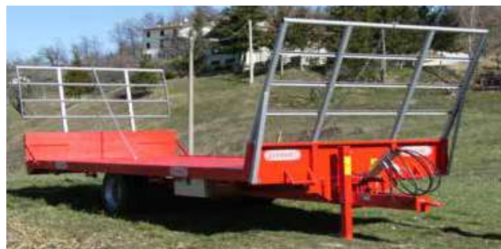
C120RP con telaio anteriore e posteriore per rotovalle
