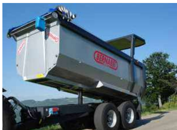
D142 con telo copri/scopri motorizzato
