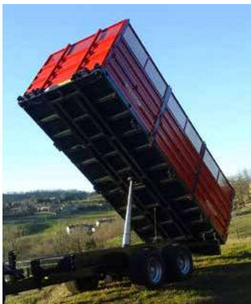
R14DU rimorchio doppio uso allestito con doppie sponde in lamiera e terzo giro in lamiera forata. Doppi piantoni laterali, sponda posteriore tipo container con rampa.
