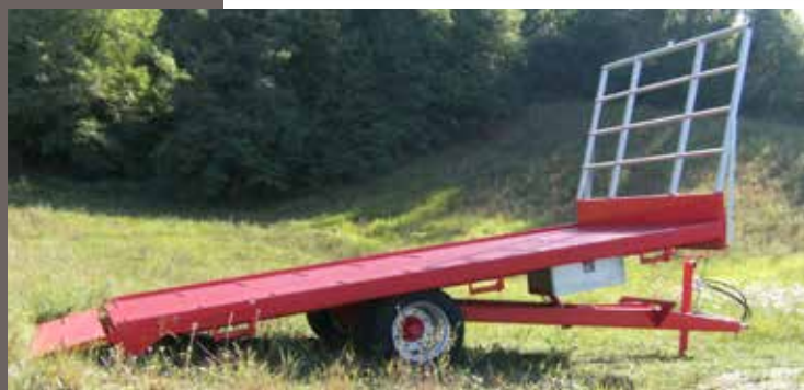
C105RP con telaio anteriore per rotovalle
