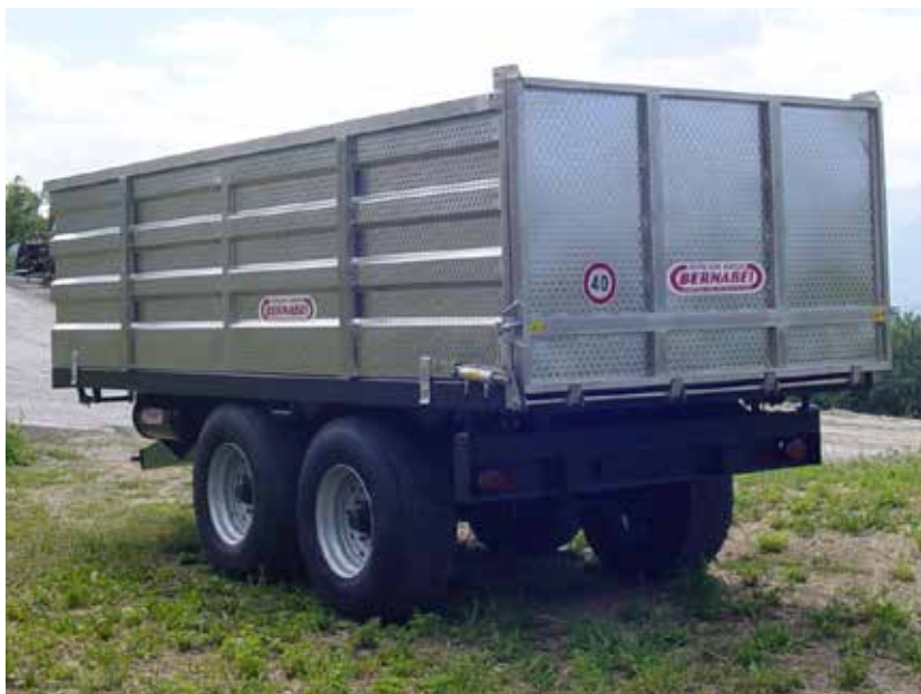
R280 allestito con vasca in acciaio inox removibile per trasporto uva, chiusura sponda posteriore idraulica
