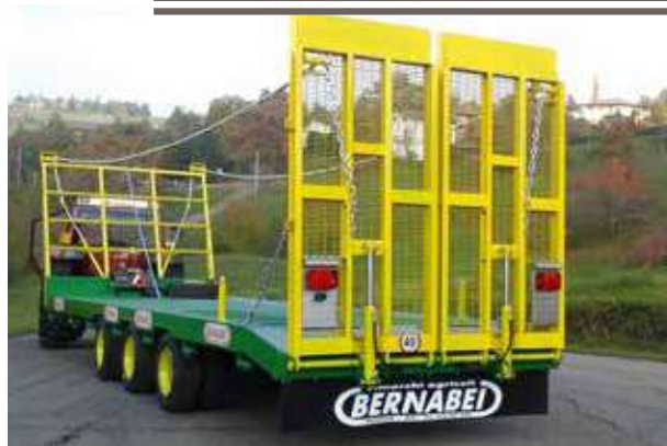
C409 allestito con pianale fisso, rampe posteriori idrauliche a griglia per trasporto mezzi pesanti, sistema di legatura, verricello idraulico.
