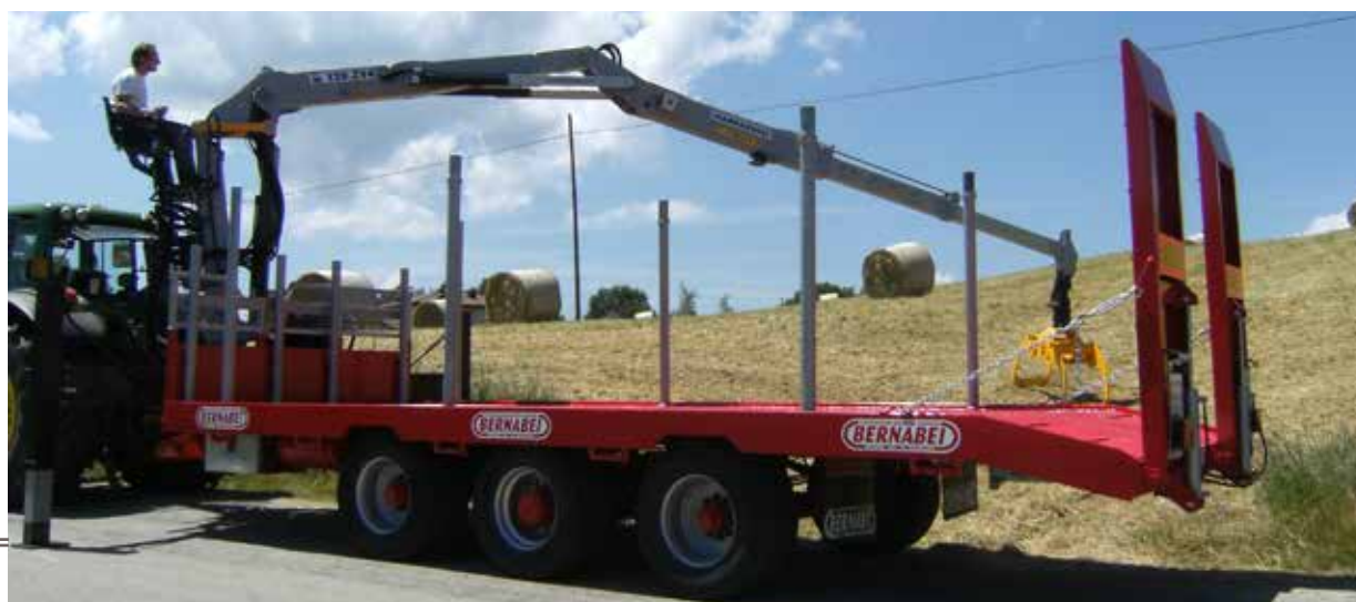
PT407G con caricatore, pali in acciaio per trasporto legna
